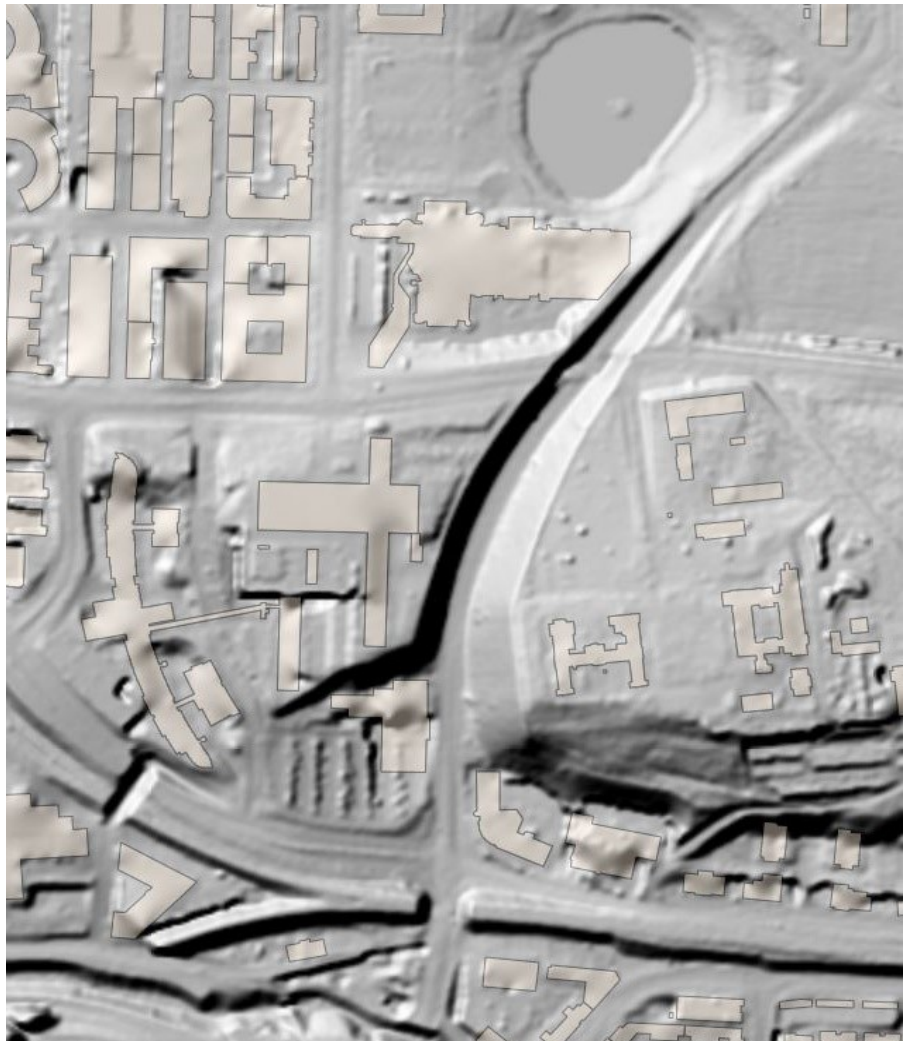
Ote Maanmittauslaitoksen korkeusmallikartasta, johon on lisätty lähiympäristön rakennukset. Viinikankatu sijoittuu voimakkaaseen maastonleikkaukseen. (Lähde: Tampereen kaupungin karttapalvelu 2021).
